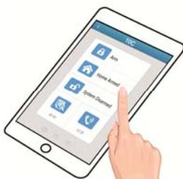
**Осторожно:** Данную функцию нужно использовать только после настройки охранных зон для работы в режиме частичной охраны. На заводских настройках: беспроводные охранные зоны 1-2 не реагируют на срабатывания в режиме частичной постановки, а беспроводные зоны 3-7 и проводная зона 3 реагируют на срабатывания.
